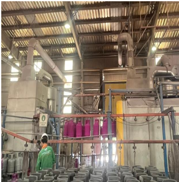
Hệ thống lọc bụi quá trình sơn sửa chai LPG xưởng mới
