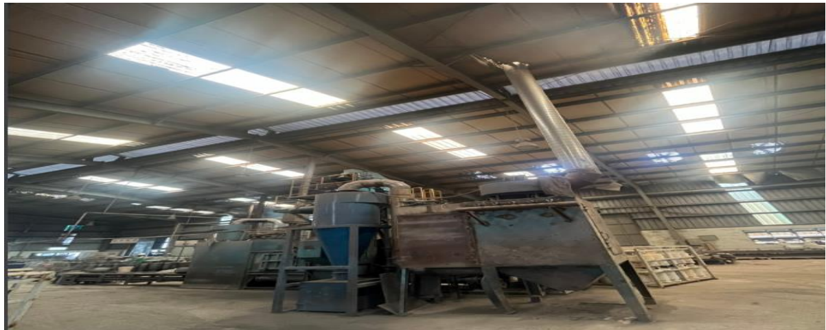
Hệ hống lọc bụi quá trình xử lý bụi từ máy phun bi xưởng cũ
