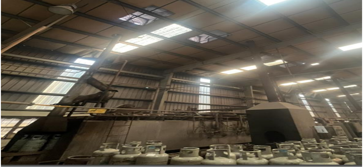
Hệ hồng lọc bụi quá trình xử lý khí thải lò đốt sơn vỏ chai LPG xưởng cũ
