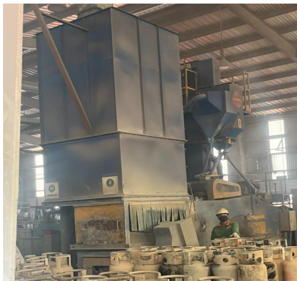
Hệ thống lọc bụi quá trình xử lý bụi từ máy phun bi xưởng mới
